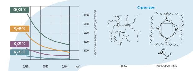
• Отсутствие адгезии (примыкания) между «барьерным» слоем и основным материалом стенки трубы, приводит к расслоению и отшелушиванию «защитного» слоя после непродолжительной эксплуатации трубопровода под давлением и с различными температурами. Не помогает и использование связующих (клеевых) слоев, не способных компенсировать значительные напряжения при эксплуатации трубопровода ввиду различных коэффициентов линейного расширения, эластичности и отличной плотности сырья.
